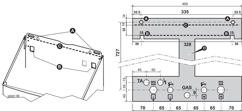
**Примечание:** Как дополнительная опция предлагается специальный металлический шаблон многоразового использования (D на рисунке), облегчающий позиционирование точек крепления (с использованием оригинального Комплекта подсоединения). Если не используется металлический шаблон многоразового использования и / или оригинальный Комплект подсоединения, о позиции гидравлических подключений котла можно прочесть в параграфе «Габаритные и присоединительные размеры» на стр. 13.
