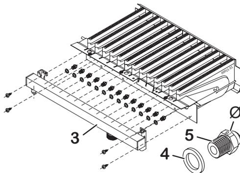
7. Снимите панель **3** и замените форсунки **5\*** на соответствующие для используемого типа газа, для этой операции необходим специальный ключ на 7 мм (см. рисунок). Число необходимых форсунок и их диаметр « $\varnothing$ » (также указан непосредственно на форсунке) приведены в таблице «Технические характеристики» на стр. 36.
